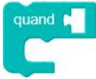
Ce bloc se combine à un « message déclencheur » pour construire un événement. Lorsque le message est propagé par le programme, le code associé au bloc **Quand** est exécuté.
